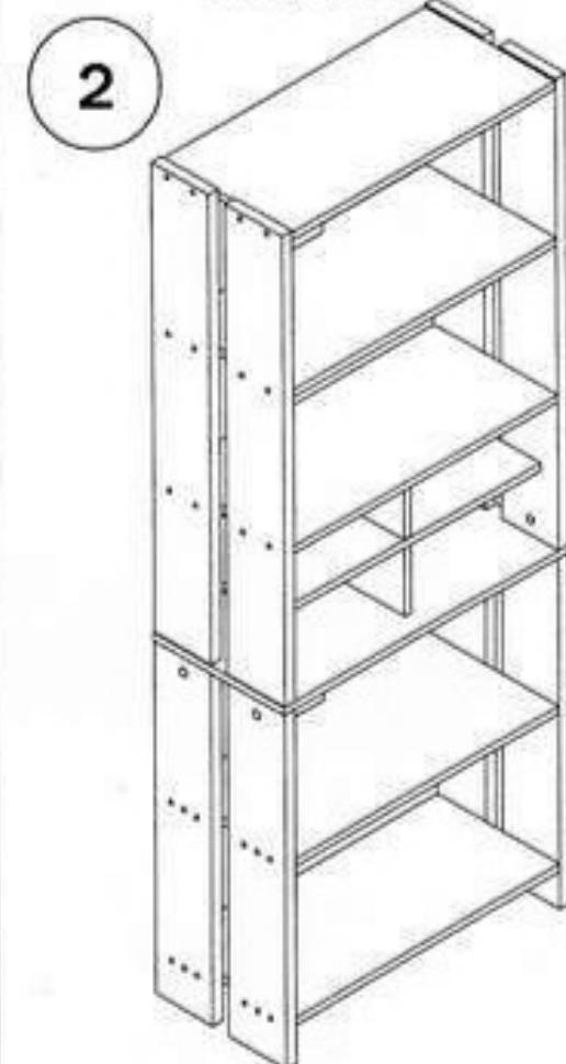
Крестообразный элемент устанавливается в свободный проем стеллажа без использования фурнитуры, и является не обязательным элементом собираемой конструкции. Поставить декоративные заглушки (4) и (9) в местах установки евровинтов (2) и стяжек-растекс (8).
